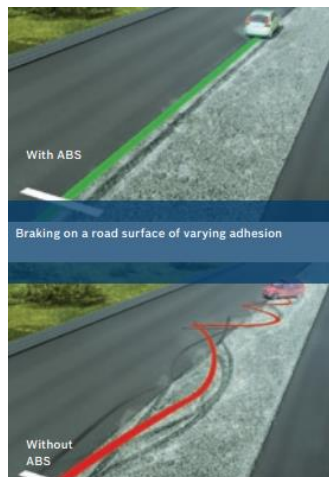
Slika 7: Simulacija učinka blokade koles z in brez ABS sistema
